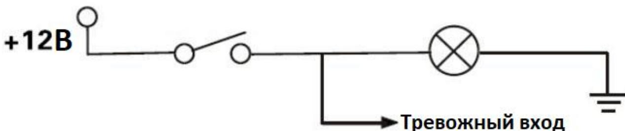
Схема подключения тревожного выхода:
