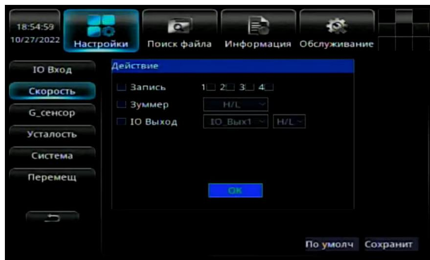
**Примечание:** для работы зуммера требуется чтобы плата устройства была им оснащена, в качестве альтернативы вы можете подключить внешний зуммер на контакты тревожного выхода устройства.
